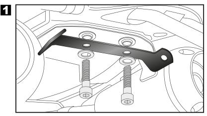
Montage Rohradapter vorne rechts/links: Die Montage erfolgt in den nun freien Gewindebohrungen mit den Sechskantschrauben M8x16 und U-Scheiben Ø8.4.
