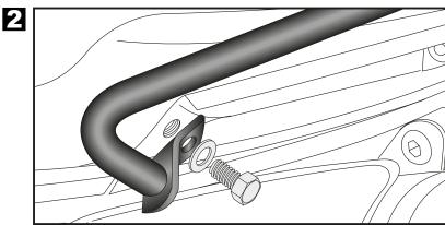
Montage Rohradapter hinten rechts/links: Die Montage erfolgt am bereits montierten Adapter mit den Zylinderschrauben M8x20, U-Scheiben Ø8,4, Karosseriescheiben Ø8,4xØ25 sowie selbstsichernden Muttern M8.
