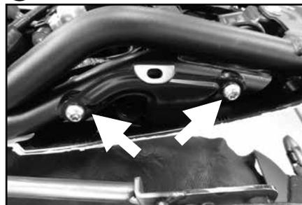
Nun jeweils das Seitenteil mit dem Halblech verschrauben, parallel ausrichten (Abb.4) und die Bohrungen markieren (Abb.5). Nun mit einem Bohrer Ø5 vorbohren, Position ggf. am Fahrzeug prüfen (Abb.6) und mit einem Stufenbohrer oder Dremel auf ca. Ø22 aufbohren (Abb.7). Alle Teile wieder montieren.
