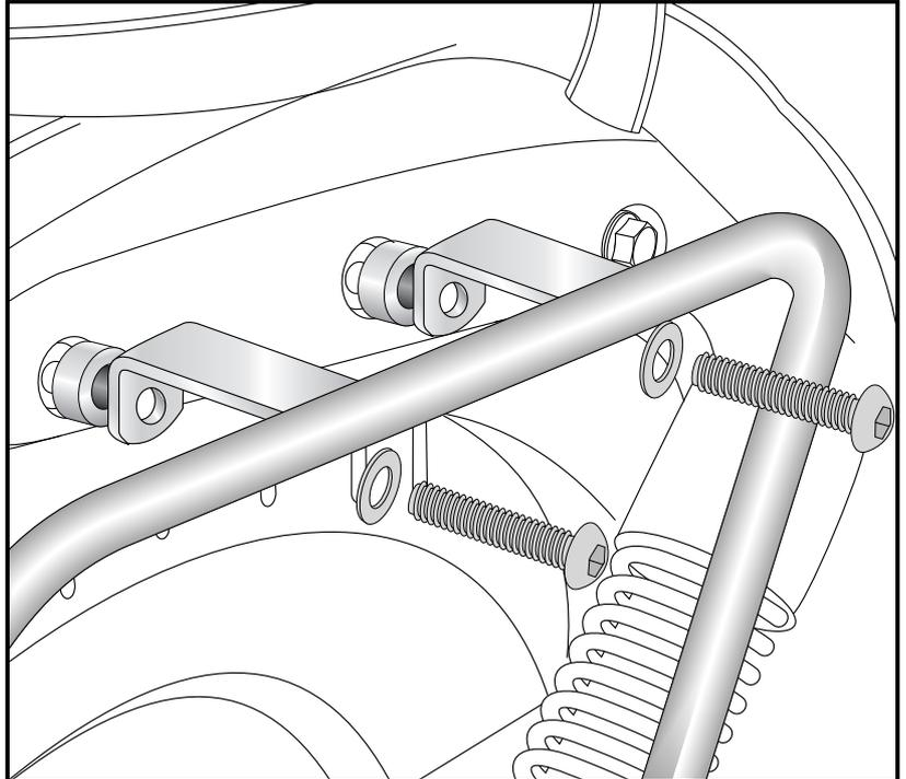
Bei zusätzlichem Anbau einer Sissybar oder Gepäckbrücke wird der Kofferträger direkt über der Gepäckbrücke bzw. der Sissybar montiert. Die Aludistanzen  $\text{Ø}18 \times \text{Ø}9 \times 11 \text{mm}$  entfallen.
