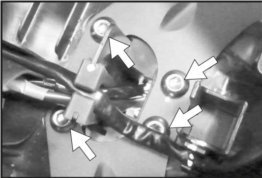
Den Soziussitz entfernen, die Kunststoffklappe öffnen und die 4 Schrauben der Kennzeichenhalterung entfernen (siehe Bild) Jeweils die hintere Schraube der Soziusfußrastenhalterung entfernen, alle Schrauben entfallen.
